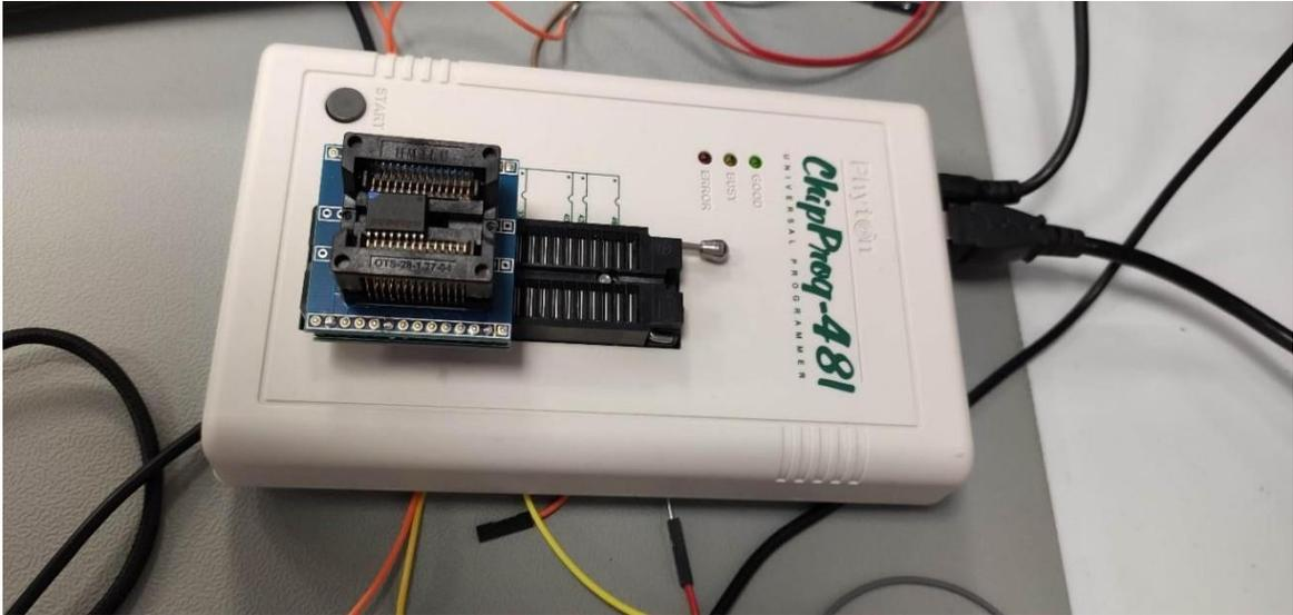
Рисунок 1 – Установка SPI-Flash памяти в адаптер, установленный в программатор
