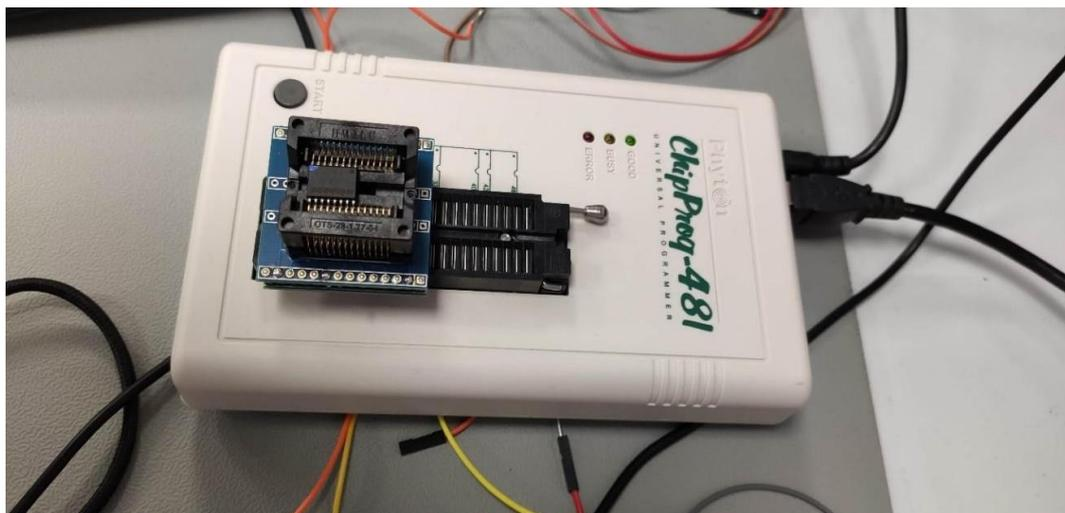
Рис.1 Установка микросхемы SPI-Flash памяти в адаптер программатора
